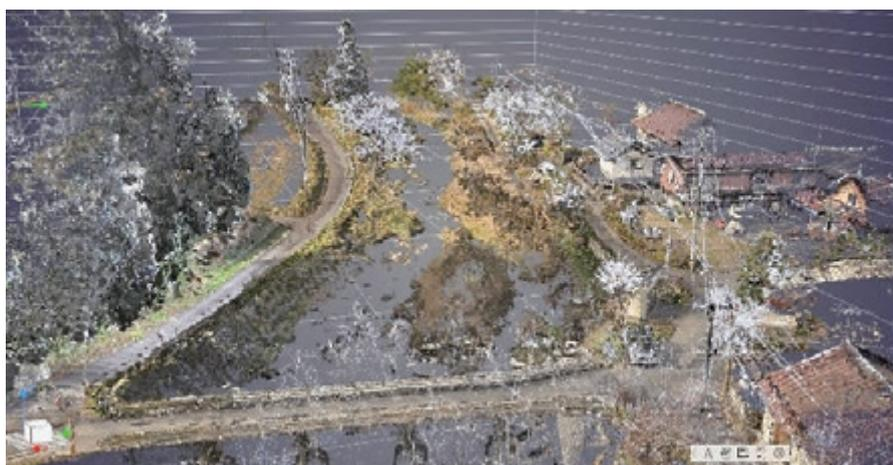
図－1 計測したオリジナルデータ（フィルタリング前）
